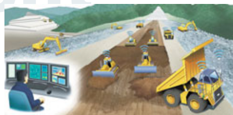
管制室から自動化重機に指示を出す
