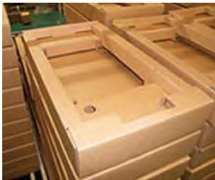
形状を工夫し緩衝材を削減したダンボール
