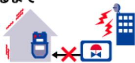
エリア内約4,000基の地震計が大きな地震を検知すると、ガス供給を自動的に遮断。さらに集めた地震情報から被害が大きい地区を推定し、地震発生後10分で遠隔遮断が可能です。
