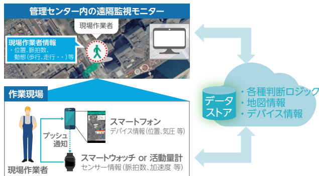
現場作業員の安全見守りシステムの概要
